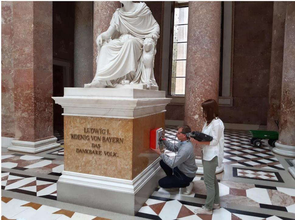
Die Bilder zeigen verschiedene RADAR-Messsysteme, mit denen sofort-bildgebend die inneren Strukturen dargestellt werden können. Die Einzelmessungen an den Objekten sind dabei innerhalb weniger Minuten pro Messprofil durchführbar. Für die Profileinmessung und die Dokumentation wird ein Kreuzlinienlaser verwendet, um Markierungen an den Strukturen zu vermeiden.
