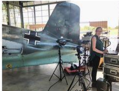
Julia Frisch (Doktorandin am Lehrstuhl für Zerstörungsfreie Prüfung) nimmt in der Flugwerft Schleißheim Thermographiemessungen vor (Bild: Prof. Christian Große)
