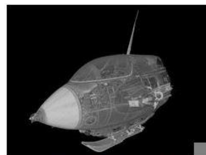
Durchstrahlungsgrafik der Me 163 (Bild: EZRT)
