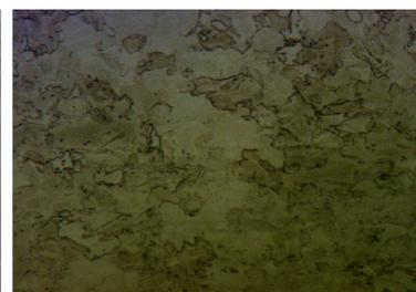
CP600 geätzt mit Kalling I
