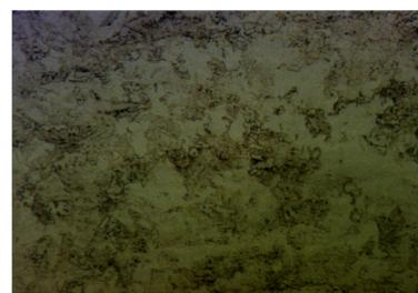
CP800 geätzt mit Kalling I
