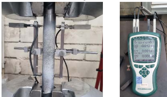
Abbildung 1: Versuchsaufbau mit dem Dehnungsaufnehmer (links) und dem Almemo (rechts)
