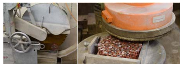
Abbildung 1: Probenpräparation durch nasses Sägen (links) und anschließendes Schleifen (rechts)
