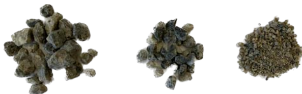
Abb. 1: Verschiedene Korngrößen rezyklierter Gesteinskörnung
